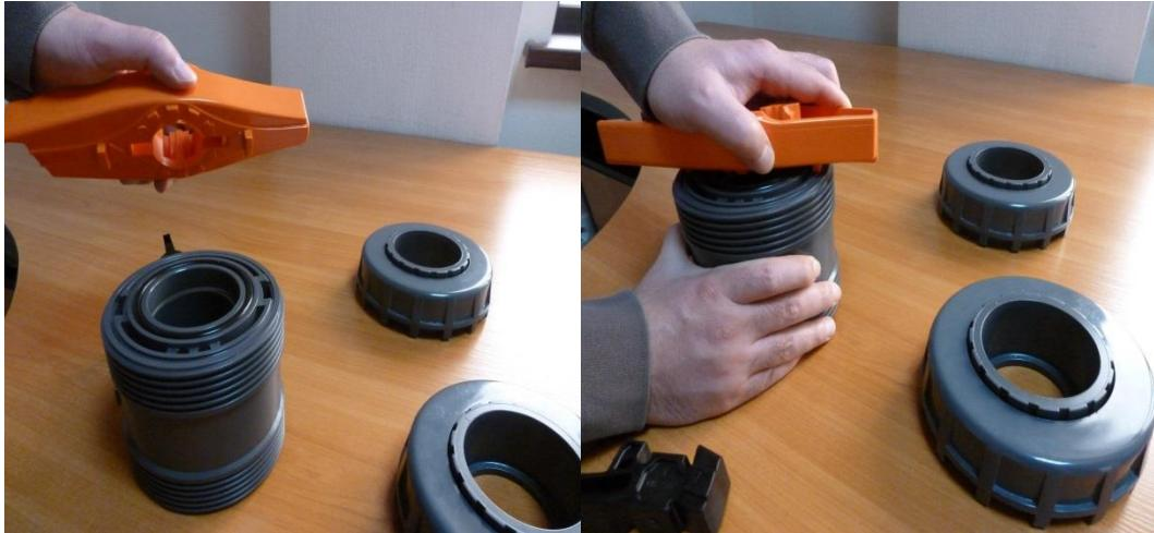
Данная модель представлена в диапазоне DN65-100. Также применена инновационная технология к ручке клапана, которая состоит из втулки, жестко закрепленной к штоку клапана и эргономичной рукоятки (штурвала), которая с помощью простой операции может быть освобождена от ступицы. С ее помощью можно осуществить регулировку седловых уплотнений клапана и с помощью вставки в виде крючка, осуществить затяжку накидных гаек.
